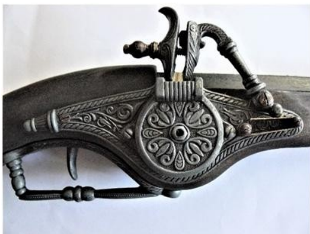
Platine à rouet d'arquebuse avec son axe de rouet qui reçoit la clef d'armement.
